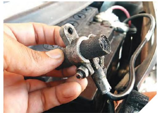
**PASO 4.** Para eliminar cualquier rastro de corrosión, pase una lija gruesa por el interior de la terminal y por el poste de la batería.
