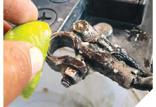
**PASO 2.** Humedezca las terminales con jugo de limón y agregue bicarbonato de sodio; la reacción desprenderá la suciedad acumulada.
