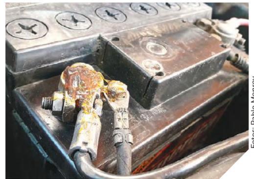
**PASO 6.** Finalmente, coloque grasa lubricante sobre las terminales para evitar que el sulfato vuelva a aparecer.
