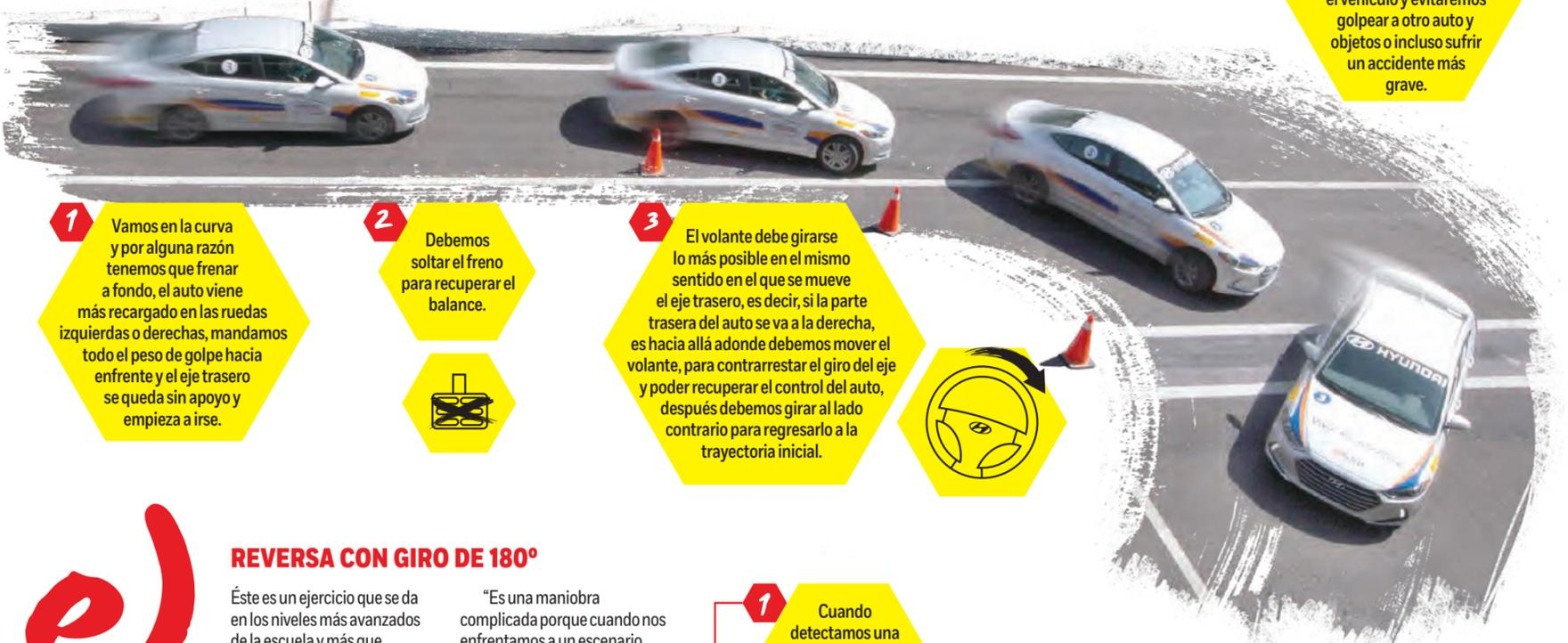
**1** Vamos en la curva y por alguna razón tenemos que frenar a fondo, el auto viene más recargado en las ruedas izquierdas o derechas, mandamos todo el peso de golpe hacia enfrente y el eje trasero se queda sin apoyo y empieza a irse.
