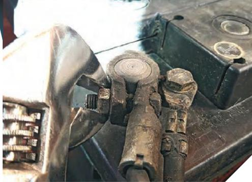
**PASO 1.** Con el coche apagado, afloje el tornillo que sujeta a la terminal del cable al poste de la batería con la ayuda de una llave.
