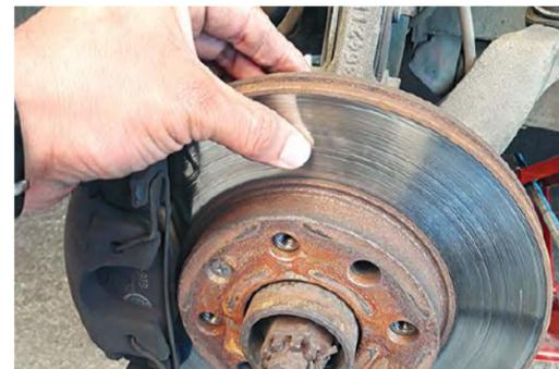
4 Puede utilizar un desarmador delgado para marcar el espesor de la balata y posteriormente compararlo con una cinta métrica. Aproveche para observar que el disco no tenga surcos muy profundos, con pasar el dedo por la superficie lo notará.
