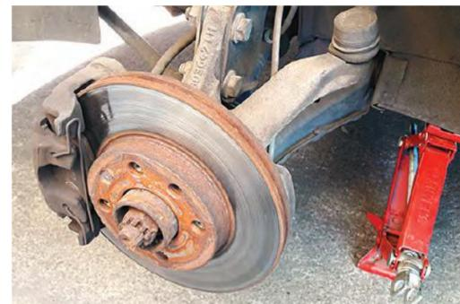
2 Al retirar la rueda se dará cuenta de que existen otros mundos ahí abajo como la suspensión, componentes de la dirección y el objetivo de nuestro consultorio: el sistema de frenos, formado por discos, calipers, balatas y la línea de líquido de frenos.
