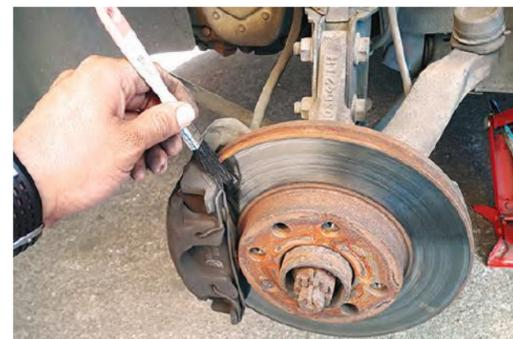
6 Si todo está en orden, antes de volver a colocar la rueda limpie el polvo del caliper y las balatas con una brocha de cerdas largas; no utilice solventes o limpiadores ya que estos compuestos pueden alterar el desempeño de las balatas cuando frene.
