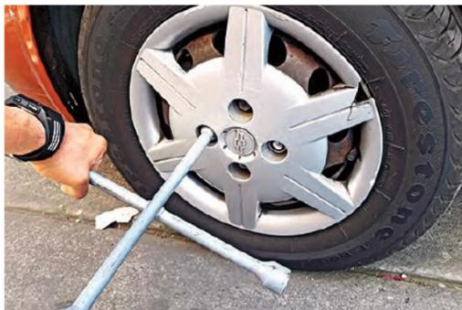
1 Para hacer la inspección, debe retirar todos los obstáculos que se lo impidan, así que irremediablemente tendrá que quitar la rueda. Hágalo con la ayuda de un gato hidráulico para levantar el coche y con la llave de cruz retire las tuercas que la sujetan.
