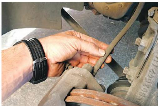
5 Y ya que estamos entrados en gastos, revise que las mangueras que llevan el líquido de frenos a los calipers no estén agrietadas o con fugas, así como cubrepolvos de las flechas de la transmisión, componentes de la suspensión y amortiguadores.
