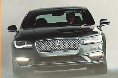
SEGURIDAD. A través de un radar instalado en la parri-lla es posible regular la distancia con respecto al auto de enfrente.
