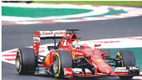
Las ruedas traseras cuentan con un sistema en los calipers del freno que recupera la energía de la frenada.
