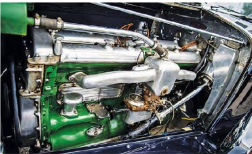
El motor Lyncoming Straight 8 cilindros DOHC, con 4 válvulas por cilindro, se mantiene trabajando a la perfección.
