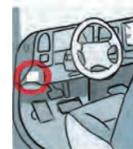
2 El enchufe se encuentra situado dentro de la cabina, generalmente cerca del asiento del conductor, aunque su posición puede variar. Es ahí donde se realizará la conexión por parte de los verificentros. Así, a través de un solo cable, se puede obtener la medición.
