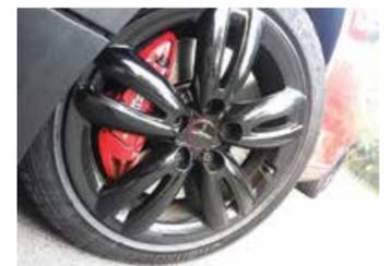
Calza rines de aluminio de 17 pulgadas y frenos de disco con pinzas Brembo.
