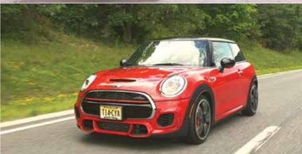
**EXTERIOR.** Las tomas de aire de la carrocería, además de otorgarle deportividad, mejoran la refrigeración del motor y el sistema de frenos.
