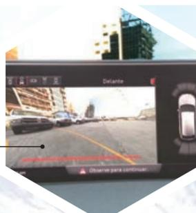
La cámara de reversa varía las perspectivas para limitar los puntos no visibles y tener una visión de 360 grados. La imagen se proyecta en una pantalla de 8.3 pulgadas.
