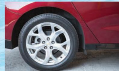
Para ayudar a mejorar la eficiencia energética del Volt, Chevrolet montó neumáticos Michelin de baja resistencia al rodamiento.
