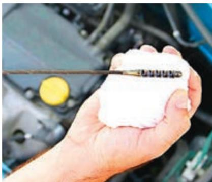
El nivel de aceite del motor debe revisarse con el motor apagado y en frío.
