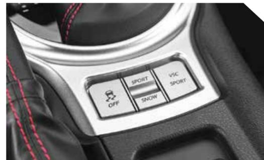
Desde aquí se puede regular el control de tracción y estabilidad para diferentes condiciones de la carretera o manejo.
