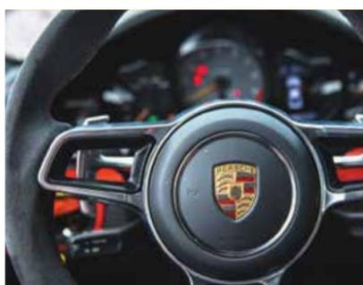
El volante está forrado con alcántara y tiene un par de paletas de metal para los cambios atrás.
