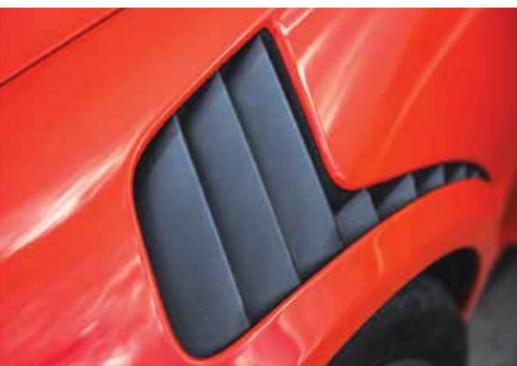
Las agallas colocadas en las salpicaderas delanteras buscan evitar turbulencias y dar apoyo aerodinámico al eje delantero.
