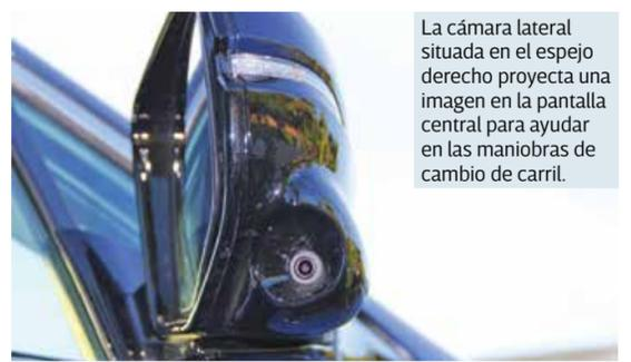
La cámara lateral situada en el espejo derecho proyecta una imagen en la pantalla central para ayudar en las maniobras de cambio de carril.
