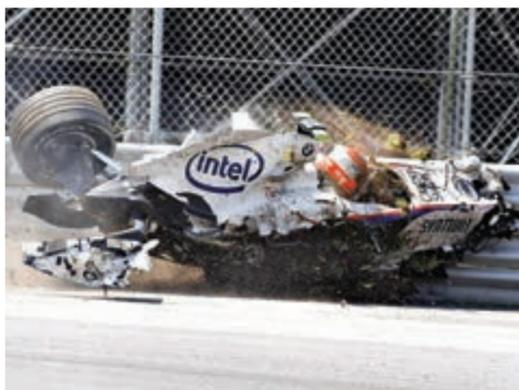
La cápsula de supervivencia se ha reforzado, al grado de soportar impactos superiores a los 300 km/h.
