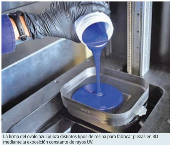
La firma del óvalo azul utiliza distintos tipos de resina para fabricar piezas en 3D mediante la exposición constante de rayos UV.
