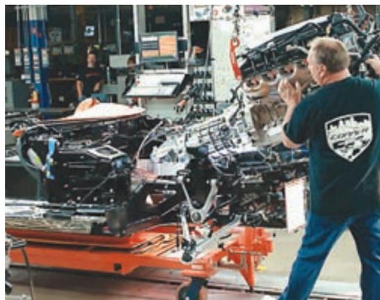
el motor y la transmisión se arman por separado y luego son instalados en el vehículo, para pasar al banco de pruebas junto al chasis.
