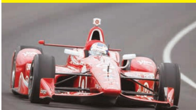
En el aerokit para los súper óvalos, el diseño parece más simple y se eliminan los alerones excedentes ya que podrían convertirse en una carga para el corte del viento.
