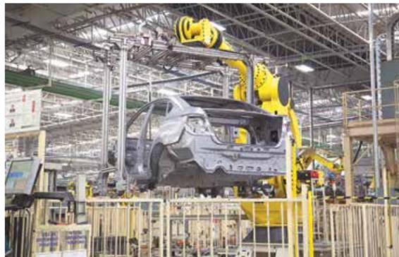
Aguascalientes II está dotada con tecnología de punta como este brazo que se encarga de mover la carrocería revisada a un carrito para continuar con su ensamble.
