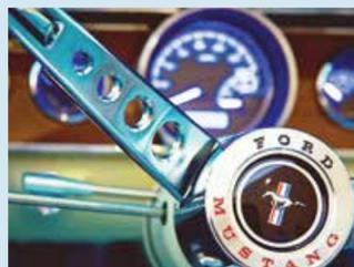
El volante es ajustable y la columna de dirección es colapsable en caso de una colisión.
