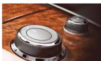
**PUESTA A PUNTO.** Es posible regular el comportamiento de la camioneta para que su conducción se adapte a distintas condiciones de manejo: Nieve, Eco, Normal y Sport.
