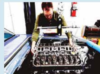
Equipa un motor Windsor V8 5.0 L. de 265 hp con inyección electrónica de combustible.
