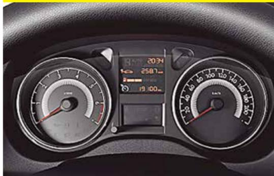
El tablero central luce el tacómetro y el velocímetro, junto con el odómetro por recorrido o tanque y el total.
