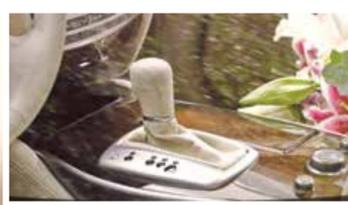
**TRANSMISIÓN AUTOMÁTICA.** Es posible manipular los cambios de la caja automática X-Tronic CVT en modo manual, con seis distintas velocidades.
