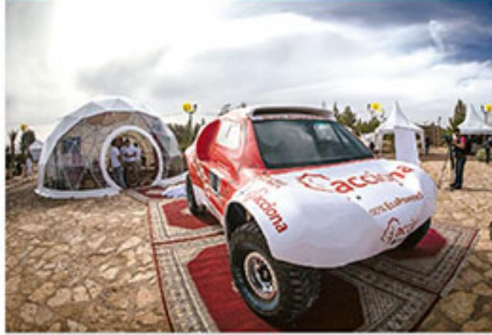
La carrocería está fabricada en fibra de carbono, debido a su ligereza y resistencia, mientras que el chasis es tubular. Además, este coche cuenta con iluminación LED para las etapas en que lleguen de noche. Los neumáticos tienen distintas medidas: 33 pulgadas para los delanteros y 35 pulgadas para los traseros.
