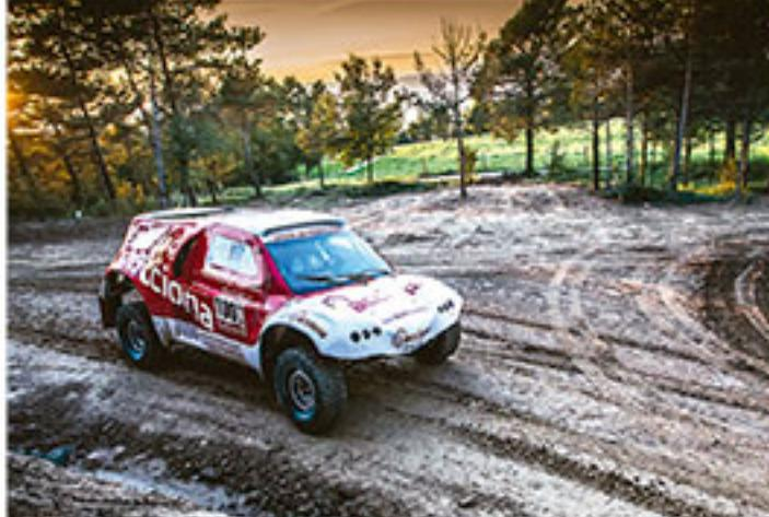
El motor eléctrico no será el único que otorgue energía al coche, además, contará con un panel solar instalado en el alerón trasero, de 0.25 metros cuadrados, que generará hasta 12 voltios para los sistemas de telemetría, seguridad del coche y navegación. Junto con ello tendrá un Sistema de Recuperación de Energía.
