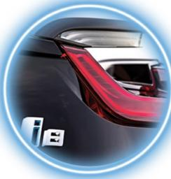
**LA FUNCIÓN SOBRE EL DISEÑO.** Las formas de las calaveras responden a la intención de mejorar la aerodinámica del i8.
