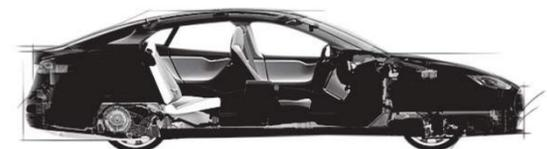
Otra de las bondades del diseño del auto se centra en las zonas de deformación progresiva de la carrocería, que absorben de manera eficiente la energía que se produce en una colisión.
