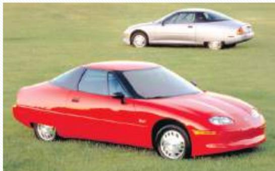
**BAJO LA PIEL.** El EV1 incorporaba un chasis de aluminio, partes de plástico en la carrocería y un coeficiente aerodinámico de 0.19.
